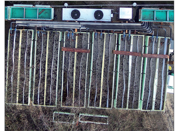
In großen Fließbrinnen-Experimenten wurde im Projekt AquaKlif das Zusammenwirken verschiedener klimabedingter Stressoren wie Niedrigwasser, Feinsedimenteintrag und Temperatur untersucht.
